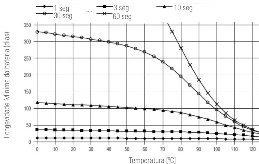
Longevidade da Bateria vs Temperatura para diferentes Períodos de Leitura rápida (Alta Resolução)
