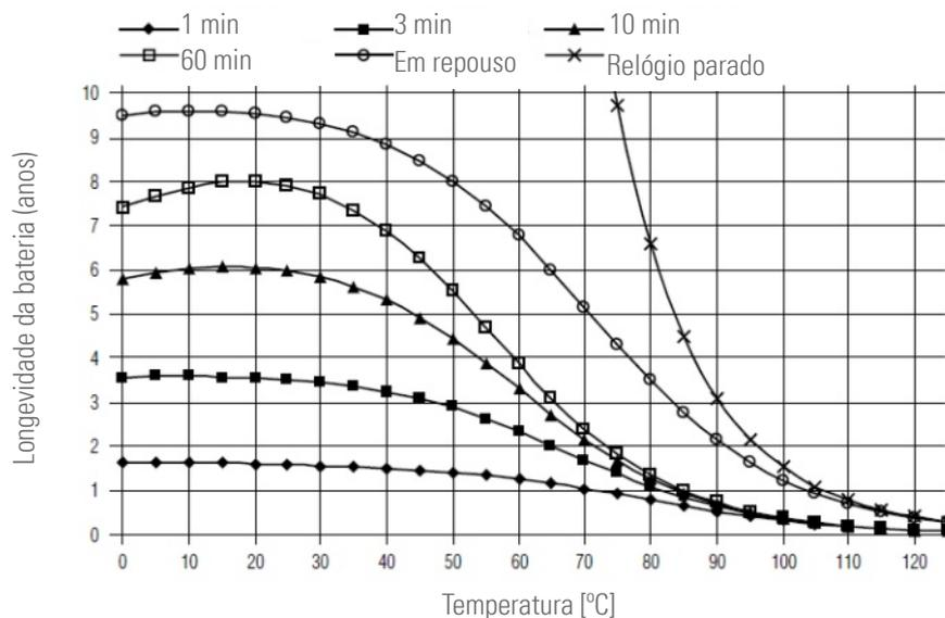
Longevidade da Bateria vs Temperatura para diferentes Períodos de Leitura (Alta Resolução)
