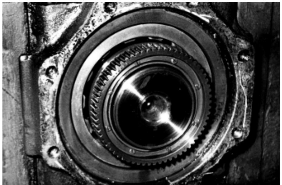
Зубчатое колесо на шейке оси колесной пары
