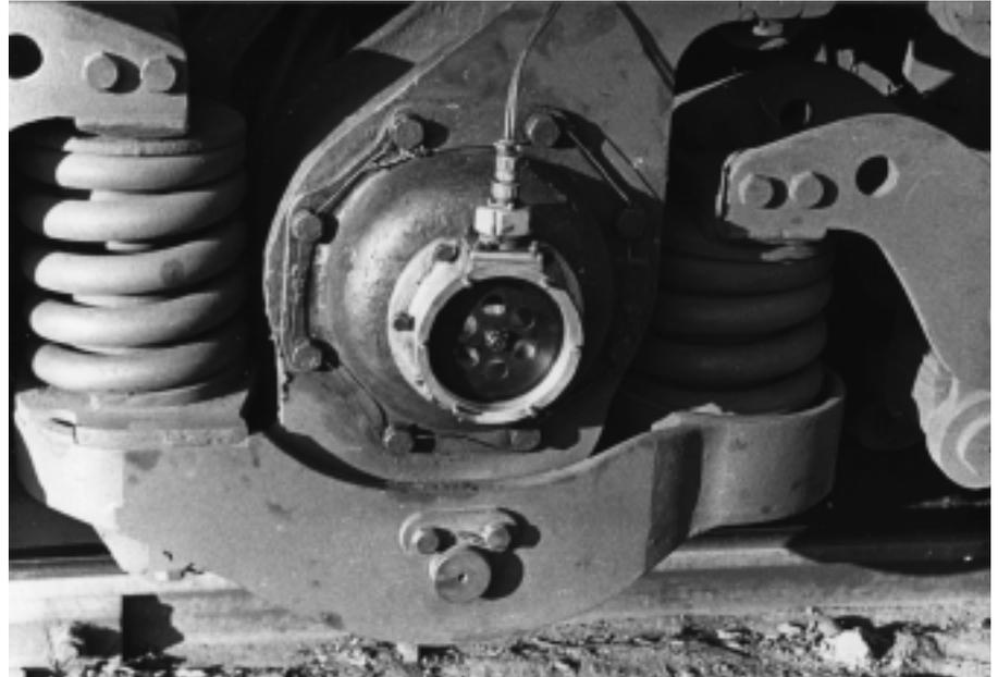
Индукционный датчик на крышке буксы тепловоза ТЭП60-707. Крышка датчика снята
