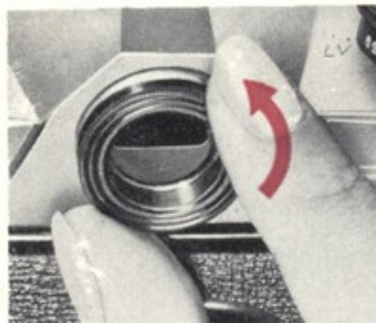
(A) ファインダーのぞき窓の黒いリングを、時計の針と反対方向に回して取りはずします。
