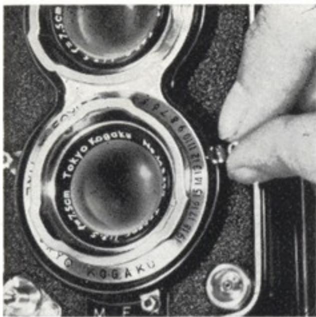
被写体の明るさとフィルム感光度によりライトバリュेを電気露出計又は簡易露出表⑩によつて求めます。ライトバリュे設定レバー⑨を動かして求めたライトバリュेに合せます。これで露光量が決まりました。上部の表示窓⑧に絞り（黒色数字）とシャッタースピード（赤色数字）が表されています。
