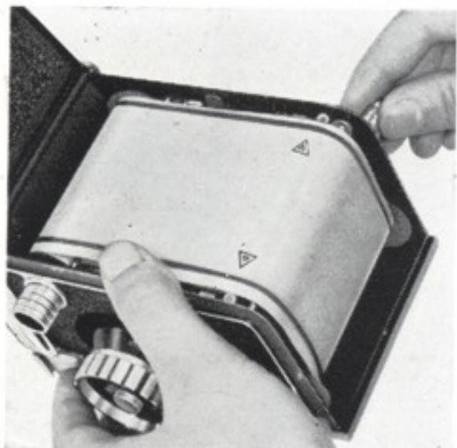
(5). 巻取りクラシクを前方に回してリーダーペーパーを巻取つて行くと、△印マークが現れます。このマークを下のフィルムローラーの近くにあるスタートマーク（赤点）に合せます。
