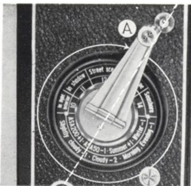
(1). 巻取りクランクを回すと“A”位置で止ります。この間はフィルムは巻取られず、撮影回数表示窓の0はそのままでシャッターのみセットされます。シャッターボタンを押してシャッターを切つて下さい。クランクは回る様になります。
