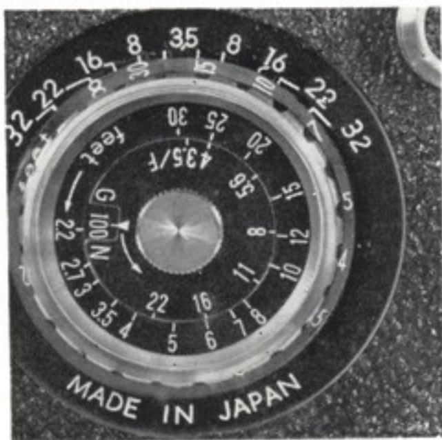
ある距離の被写体にピントを合わせた時、その物の前後それぞれある範囲内の物にも实用上差支えない程度にピントが合っているのですが、その範囲を被写体深度（焦点深度）と言い、それを簡単に見るのに、被写体深度目盛環を使います。被写体深度は、被写体までの距離、絞りの大きさ、焦点距離及び許し得るボ
