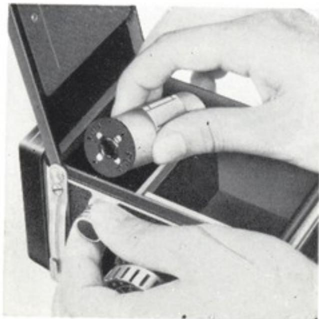
(1). 裏蓋開閉環を矢印の方向へ静かに回します。裏蓋締め金具が上へ持ち上げられて裏蓋が開きます。
