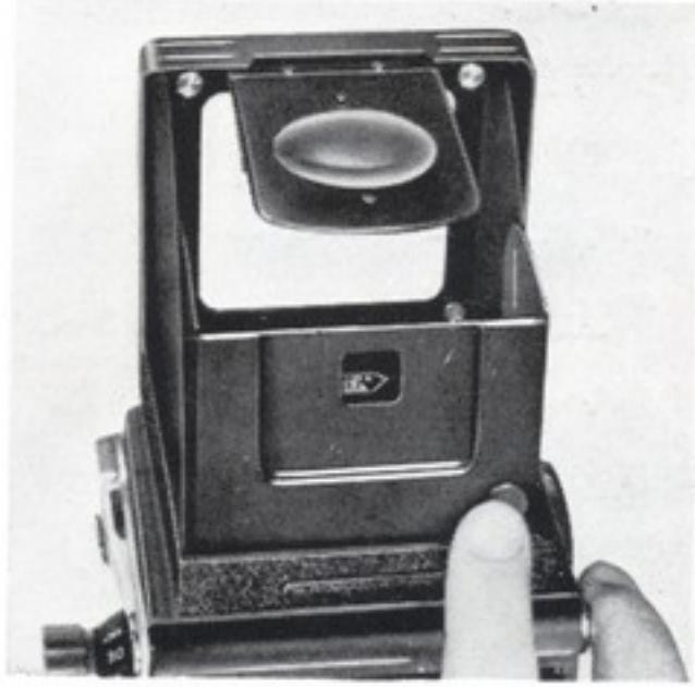
透視ファインダーフラップを奥の方に倒すとフード内部の止金にかかると止まります。覗窓から見える前枠の範囲内の被写体がフィルムに写り直接にスポーツファインダーとして使用出来ます。元へ戻すにはフラップ止めボタン④を押しますと自動的に戻ります。
