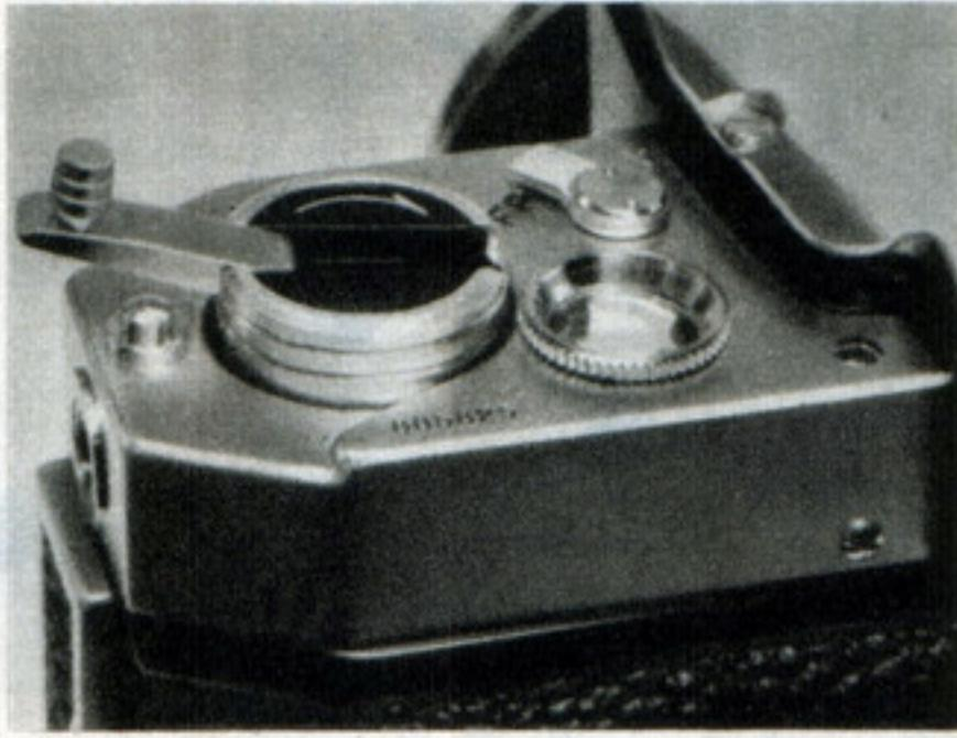
巻戻しはノップを引起す折畳式のクランクハンドルによって行われる。巻戻部の左横とボディ側面にアクセサリーシュー'をネジで取付けられるようになっている。
