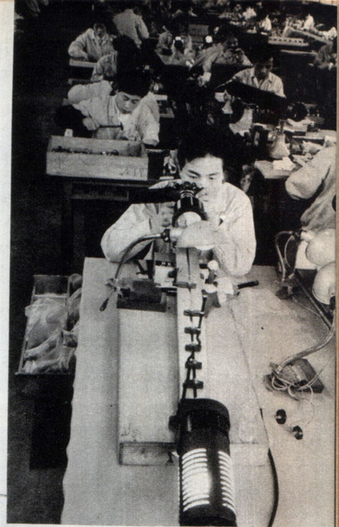
↑距離計の検査はこのような機械で行われる 正確に運動しピッタリ合わなければならぬ大切な検査部署だ
