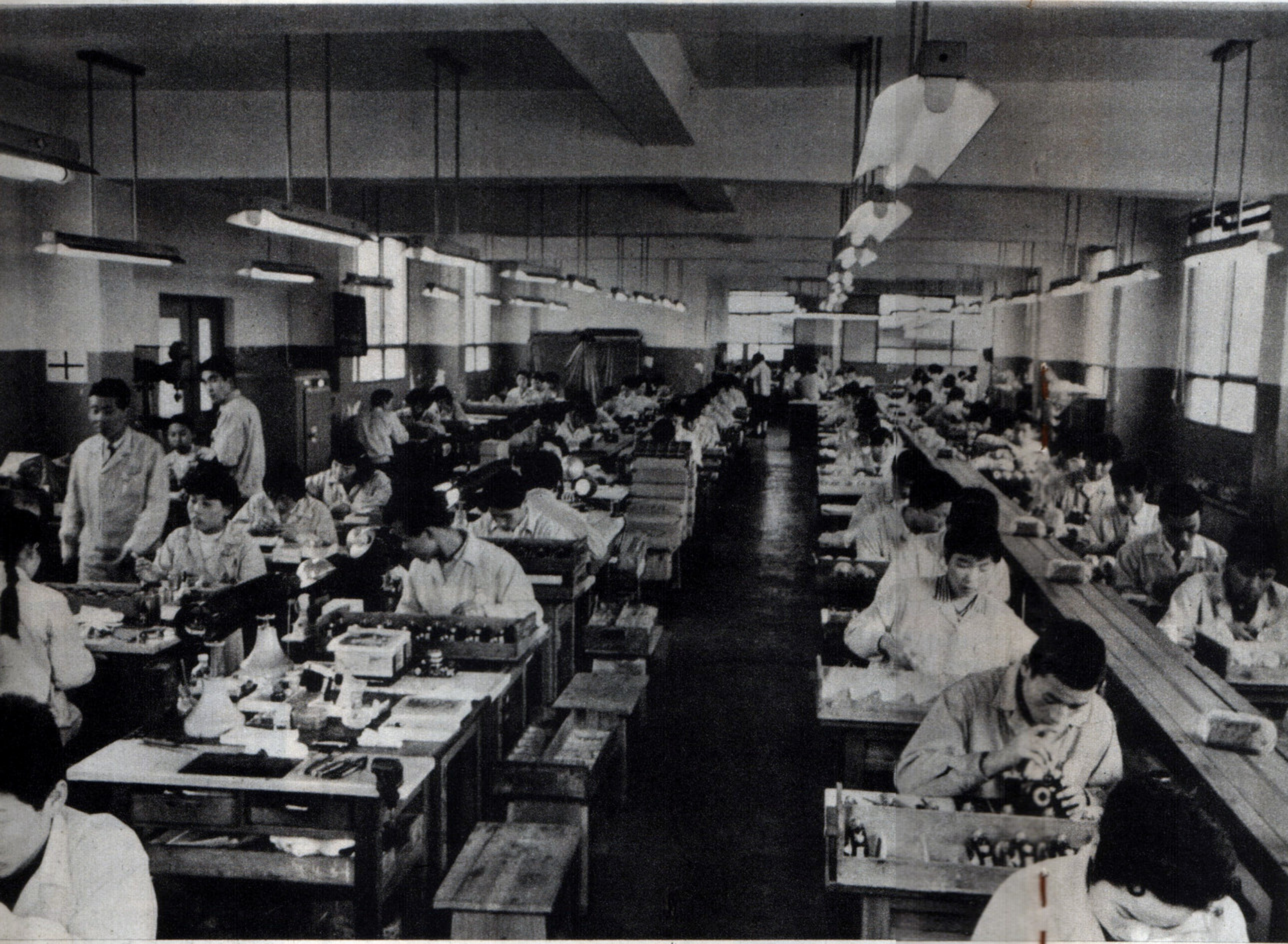
組立工場 中央通路の右側にベルト・コンベアーがボディをのせてゆっくり動いている 左側は鏡胴部の組みみやピント調整に忙しい
