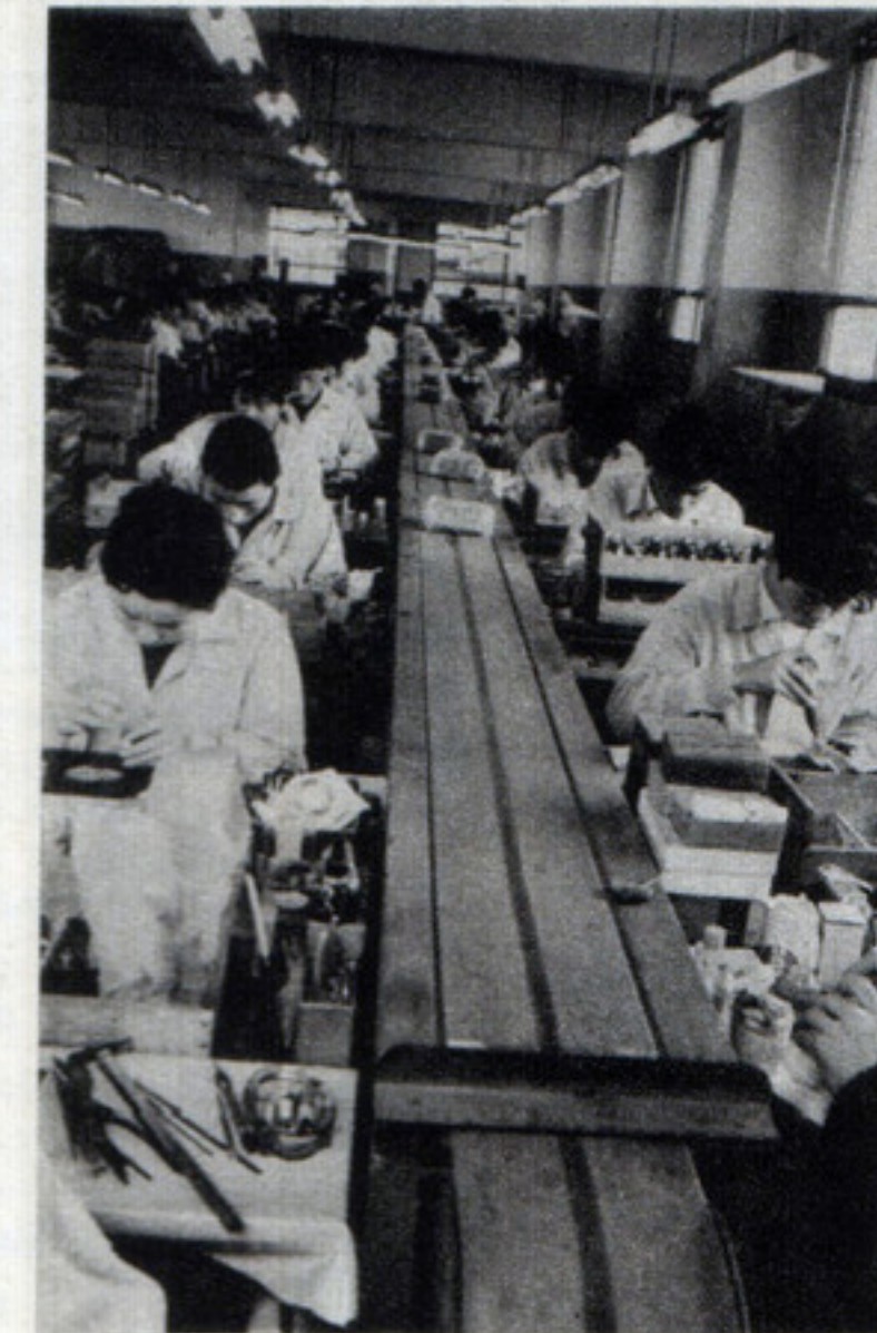
ボディがベルト・コンベアーによって流れてくる 両側の作業員は部品の取付けビス打ちに機械のような正確さで休みなく手を動かしている
