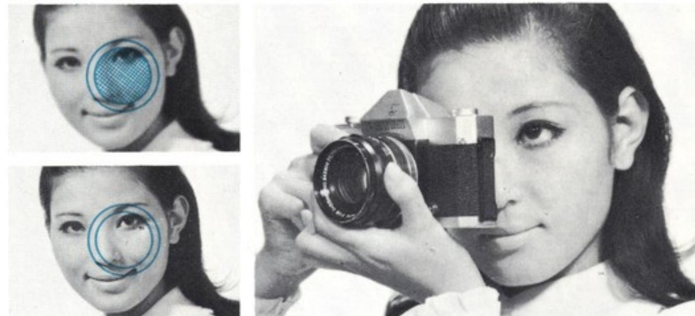
右か左に回すと、マイクロイメージがいちばんシャープな像を結ぶ位置があります。それがピントの正しく合った位置です。このマイクロイメージは、ピントが少しでもズレていると像がかくずれてチラチラしますので、容易にピント合わせができます。
