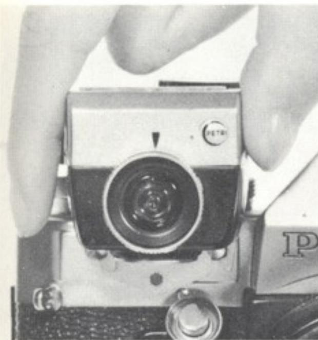
1. メーター側面の取付けレバーを押しながら、取付け金具をカメラの取付けピンに差しこみ手を離せば固定します。メーターのシャッターダイヤルを左右に回すと、メーター底部のカップラーがカメラのダイヤル上のピンと結合し、メーターとカメラのダイヤルが連動します。
