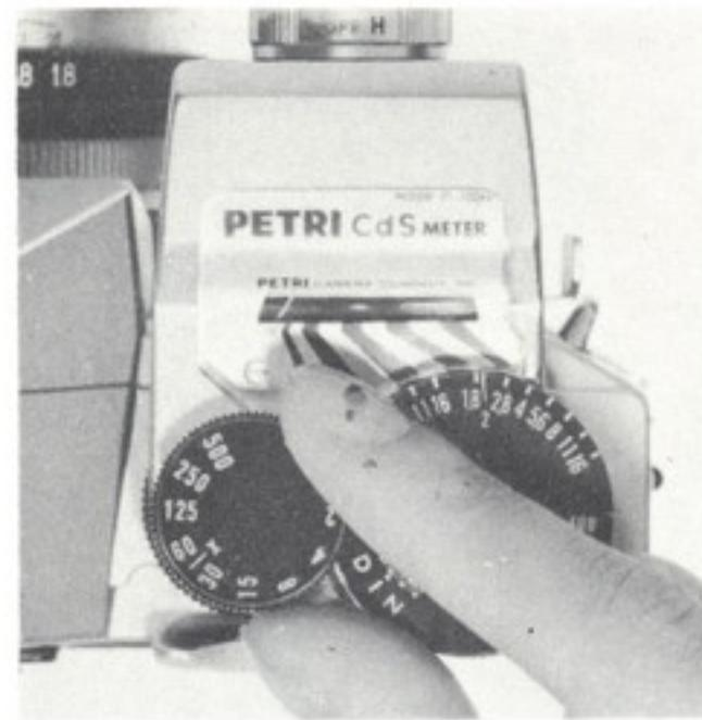
2. 紋りダイヤル上のピンに爪をかけて回し、ASA (DIN) 感度目盛を使用フィルムの感度に合わせます。
