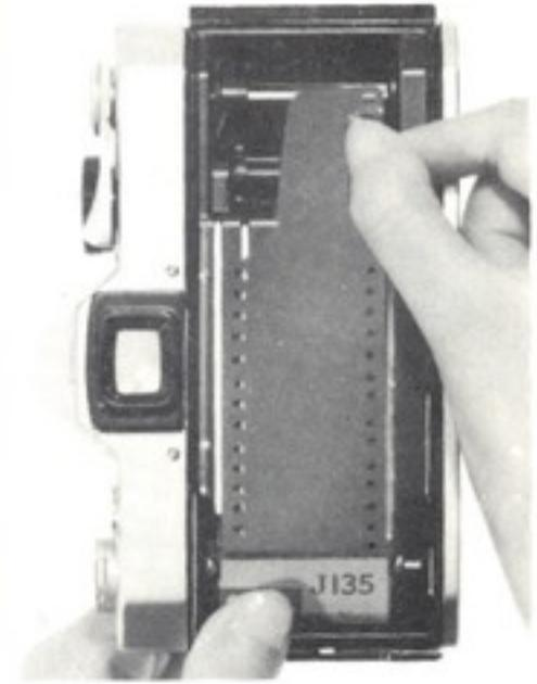
3. 左手で軽くパトローネをおさえながら、フィルムの先端を巻取軸に刻まれた4ヶ所の溝のどれにも差します。
