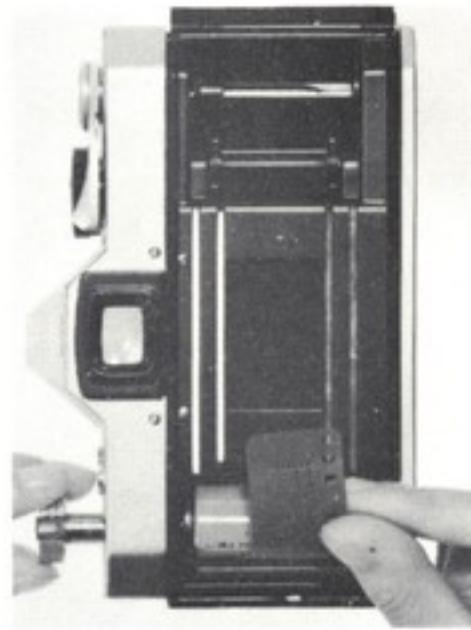
2. 巻戻しクランクを止るまで引出し、フィルム室にフィルムを入れ、巻戻しクランクを元に戻します。元の位置に戻らないときは、左右に少し回しながら押込むと完全に入ります。
