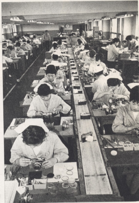
→ 質管票による厳密な品質管理がベルトの上でもなされる
