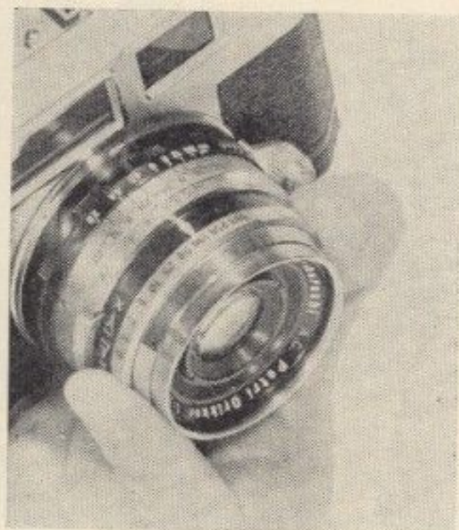
シャッター速度目盛の調節は鏡胴周囲のリングを廻して指標に合わせます。絞り目盛も同様です。
