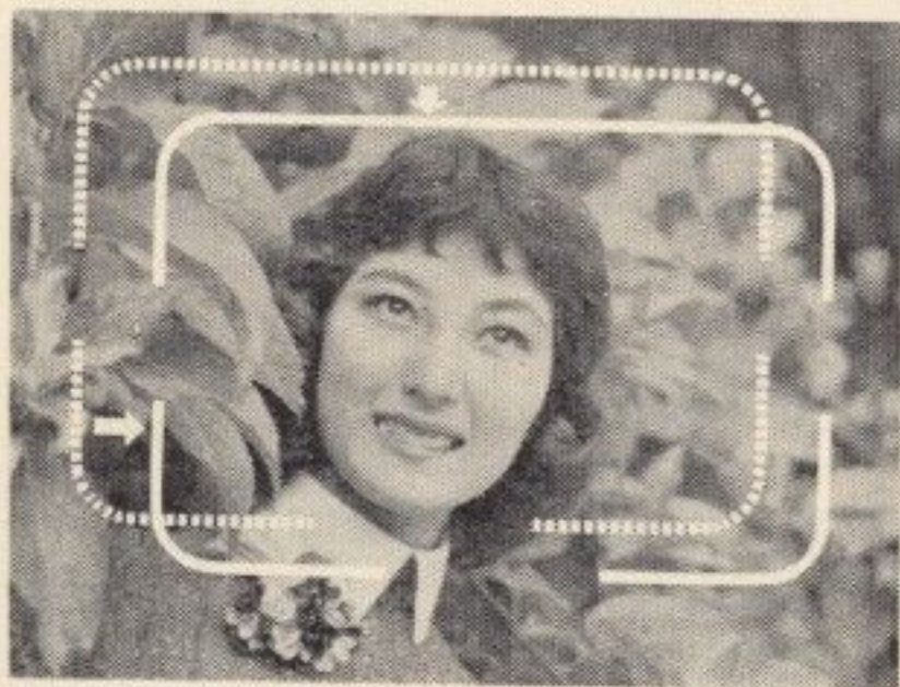
ブライトフレームによるパララックス自動矯正 （実線が2.8フィート、点線が無限大の場合）
