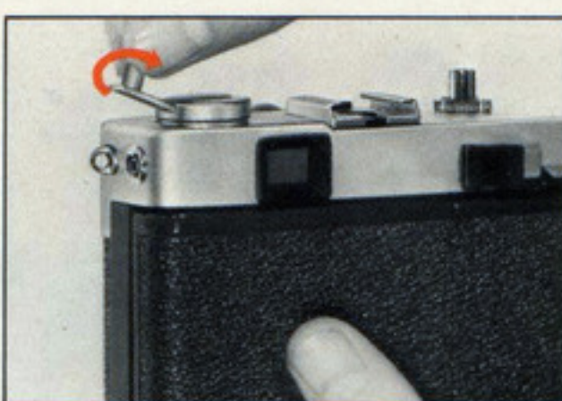
②フィルム巻戻しクランクFを起し、矢印の方向に回すとフィルムはバトロネの中に巻戻されます。
