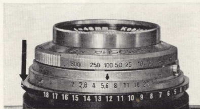
矢印のところを押し込んでいけば 絞りリングだけ回せる
