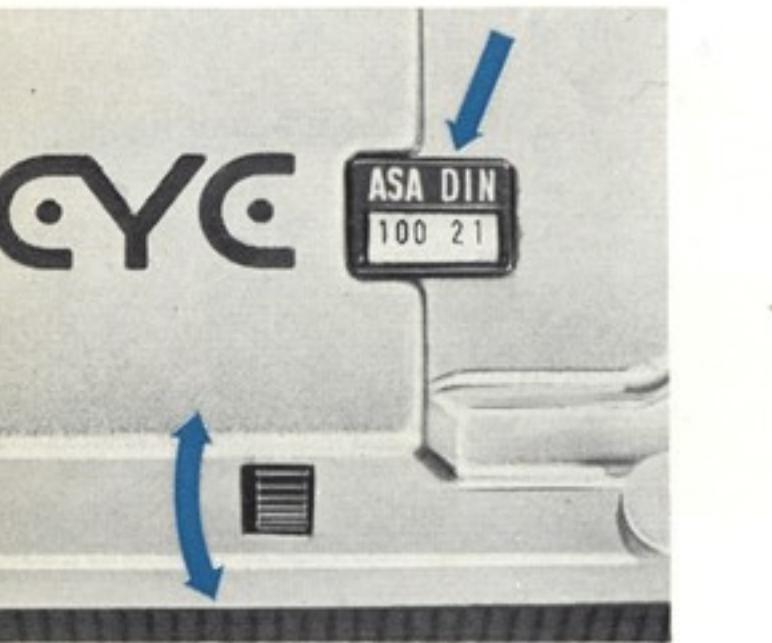
カメラにフィルムを入れたら、使用フィルムの感度（ASA）に相当する目盛を正しく合わせておいてください。フィルム感度ダイヤルを指先で回すと上部の窓に感度目盛が現われます。各目盛ごとにクリックストップになっています。
