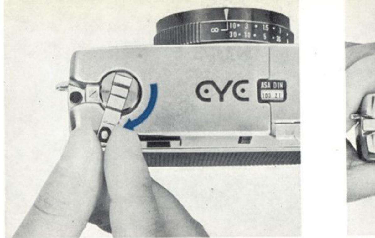
⑤巻戻しクランクを矢印の方向に静かに回して、パトローネ内のフィルムのゆるみをなくしておきます。それから巻戻しクランクを元の位置にたたんでおいてください。
