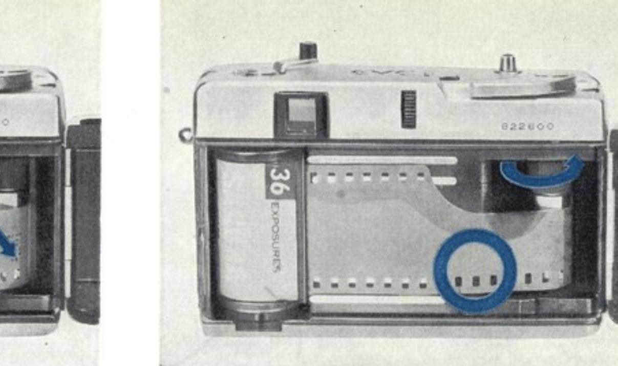
④巻取りスピールを指先で回し、二回ぐらいいofilムを巻きつけ、パーフォレーションとスピケット（フィルムを送る歯車）の歯がカミ合っているのを確かめた上で裏ぶたを閉じます。
