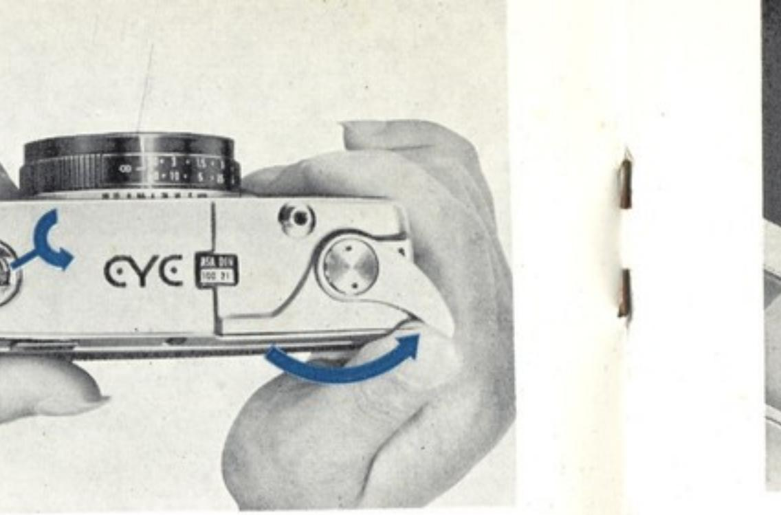
⑥フィルムを巻上げシャッターをきり、カウンターの1の目盛の前のポチが指標にくるまでカラ写しをおこなってください。この巻上げのとき、巻戻し軸の部分が回転すればフィルムは正しく巻上げられています。
