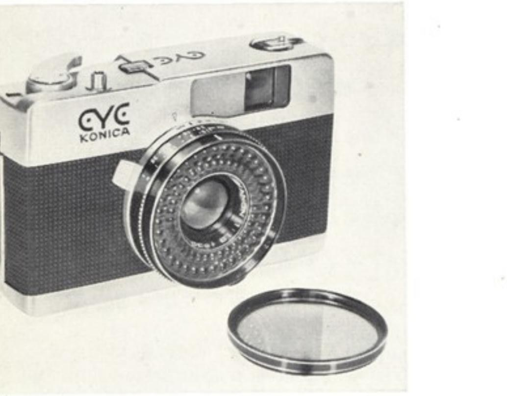
コニカアイのフィルターは金属枠付ねじ径**46ミリ**ピッチ**0.75ミリ**のねじ込み式を使用します。
