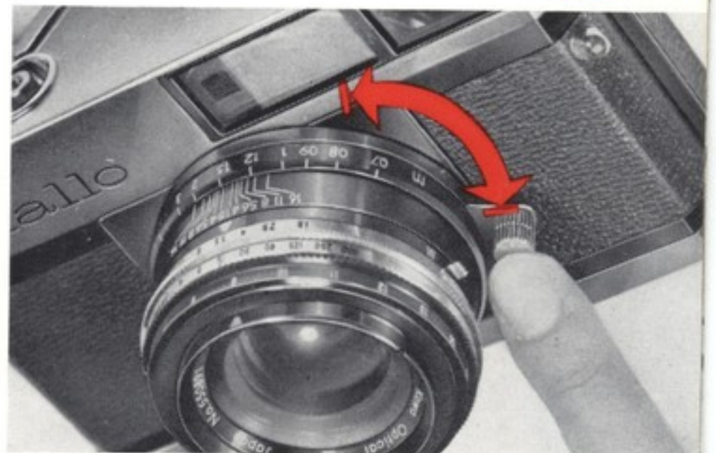
4 ．ヘリコイドレバーを廻し距離計像を合せます。
