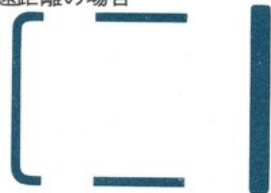
パララック自動補正説明図 遠距離の場合
