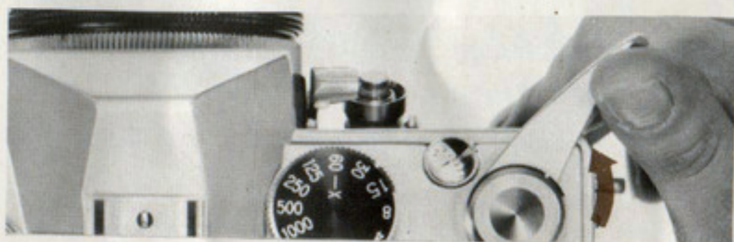
7. 巻上げレバーを巻上げ、シャッターを切る操作を空写しといますが、これをフィルム枚数計が1を指すまでくり返し、ここから撮影に入ります。この空写しの途中で、巻戻しクランクが巻上げにつれて回っていれば、フィルムは正しく送られています。
