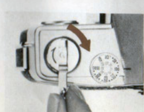
6. 裏ふたを閉じ、念のため巻戻しクランクを起し、クランクが重く感じるまで軽く回して、フィルムのタルミをとります。
